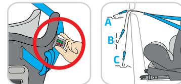
Befestigen Sie den Gurt mit **BEIDEN** blau markierte Gurtführung an der Rückseite des Sitzes.
