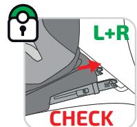
Beide Sicherheitsindikatoren müssen jetzt grün sein. Bitte prüfen Sie anhand der Sicherheitsindikatoren an BEIDEN SEITEN, ob der Sitz richtig mit beiden ISOFIT-Ankern (IA) des Autos verbunden ist.
