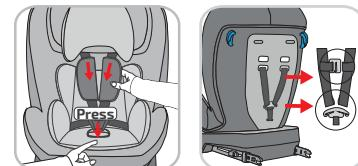
Um den Schrittgurt zu entfernen schieben Sie den Gurt zusammen mit der Metallplatte von unten nach oben aus dem Sitzteil.
