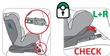
Nur eine korrekte Befestigung BEIDER KLEMMEN gewährleistet den vorgesehenen Halt des Sitzes und die Sicherung Ihres Kindes im Fahrzeug!!!
