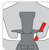
Guidez maintenant la ceinture abdominale (W) avec la languette de verrouillage (V) sur les guides de ceinture rouges du siège enfant vers la boucle de ceinture à trois points et engagez la languette de verrouillage (V) de la ceinture à trois points du véhicule dans la boucle de ceinture à trois points avec un <>CLICK>> audible.
