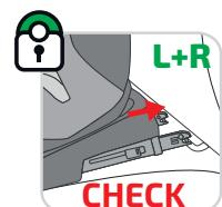
ISOFIT montaj noktaları, koltuk oturma yeri ile koltuk sırt dayama kesişimi arasında bulunur.
